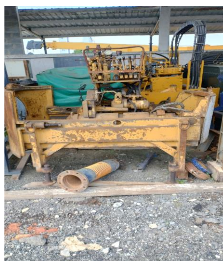
Vista Perfuratriz HDD Bohrtec
