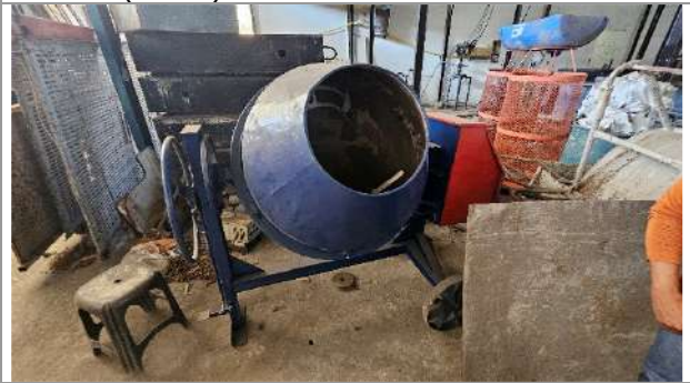
Betoneira de 400 litros
