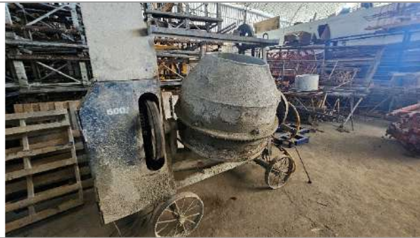
Betoneira de 600 litros
